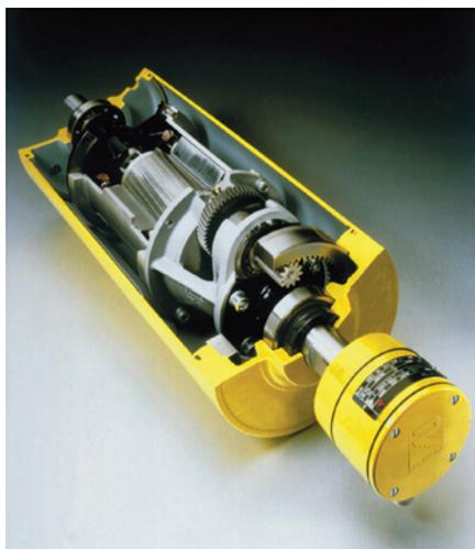
Figura 1. Un Polea Motorizada sella el motor y la caja de engranajes dentro de una carcasa de tambor llena de aceite.
