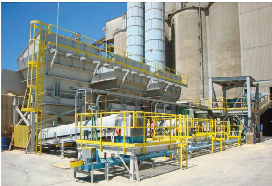
Figura 3. Tres transportadores alimentadores con transmisión por Polea Motorizada en el nuevo sistema receptor de “yeso sintético” en Greencastle, IN.
