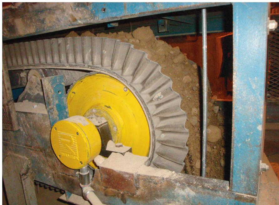
**Figura 7.** Este transportador dosificador de rocas pesadas tiene una banda de 30 pulg. (76.2 cm) de ancho con paredes laterales de 4 pulg. (10.2 cm) y es accionado por un Polea Motorizada de 5.5 HP y diámetro de 16 pulg. (40.6 cm) a una velocidad de entre 0.8 y 80 pies por minuto (14.6 y 1463 metros por segundo).
