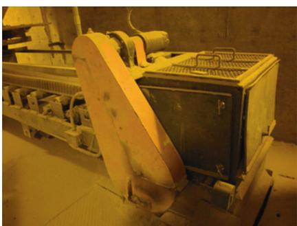
Figura 2. Un sistema de transmisión expuesto requiere protección extensa para resguardar el motor, la caja de engranajes y al personal.
