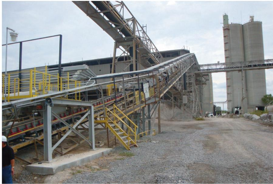
Figura 4. El transportador de recuperación núm. 1 en la planta de Pryor eleva el material a 138 pies (42.1 metros).
